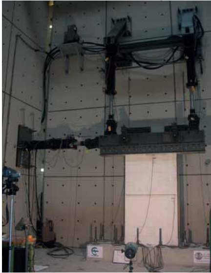
Progetto ESECMaSE: set-up e strumentazione di prova del laboratorio EUCentre di Pavia.
