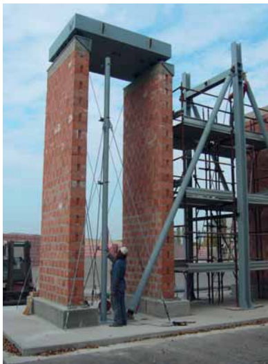
Progetto DISWall: prototipo delle pareti armate con le strumentazioni per la prova critica fuori piano e modello agli elementi finiti implementato per analisi dinamica (sperimentazione sviluppata dai ricercatori del Dipartimento di Costruzione e Trasporti dell'Università degli Studi di Padova).
